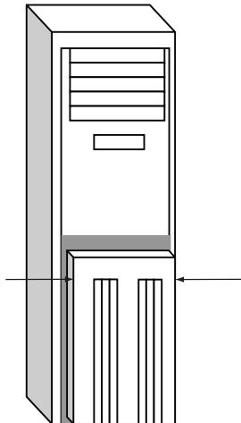
**1 ШАГ.** Извлеките заглушку из нижней панели. С помощью отвертки выкрутите шуруп.
