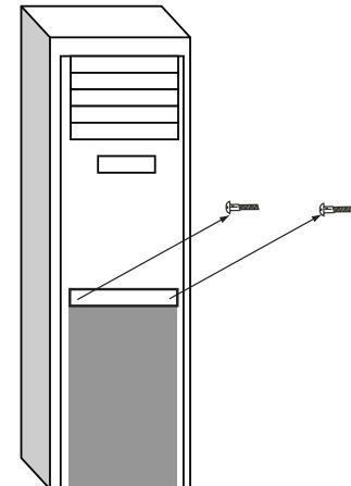
**4 ШАГ.** Для того, чтобы освободить от пакета угольный фильтр (Carbon фильтр и NANO фильтр: два в одном), выкрутите шурупы из металлической пластины, фиксирующей фильтр.
