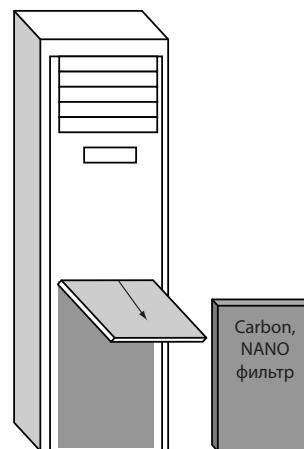
**5 ШАГ.** Потяните вниз запаянный в пакет угольный фильтр (Carbon фильтр и NANO фильтр: два в одном), вытащите его из прибора и освободите от пакета.
