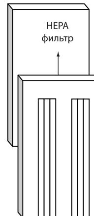
**3 ШАГ.** Выньте HEPA фильтр из кассеты передней панели, потянув его вверх.
