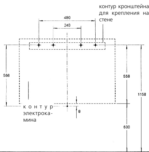
Иллюстрация 2: Рекомендуемые крепежные размеры
