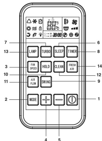
ти: AUTO (АВТОМАТИЧЕСКИЙ), COOL (ОХЛАЖДЕНИЕ), DRY (ОСУШЕНИЕ), HEAT (НАГРЕВ), FAN (ВЕНТИЛЯТОР). На дисплее пульта высвечиваются соответствующие знаки индикации режимов:
