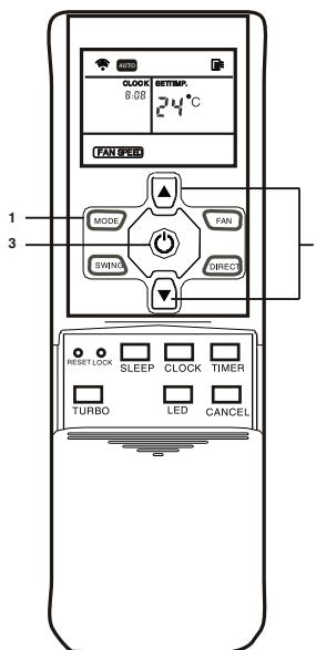
Когда вы устанавливаете автоматический режим работы кондиционера, кондиционер выбирает необходимый режим работы (охлаждение, обогрев или вентиляция) в зависимости от установленной пользователем температуры на пульте ДУ, и температуры в помещении. Если вам необходимо выключить кондиционер нажмите кнопку (ON/OFF).
