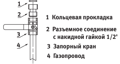
Подсоединение газопровода природного газа
