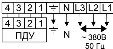
Подключить сетевой кабель и ПДУ согласно маркировке рядом с клеммной колодкой.
