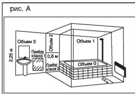
**Объем защиты** Этот прибор может быть установлен в объеме 2 или 3 при условии, что электрическое питание будет защищено устройством защитного отключения (УЗО), равным 30 мА.
