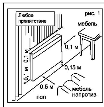
Избегать расположения за занавесками, дверьми или под отверстием пропускающим воздух.
