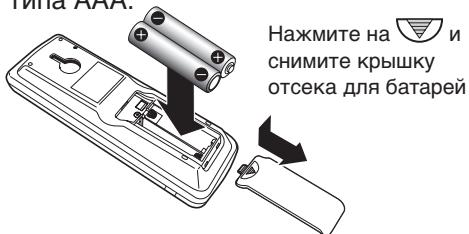
Нажмите на и снимите крышку отсека для батарей
