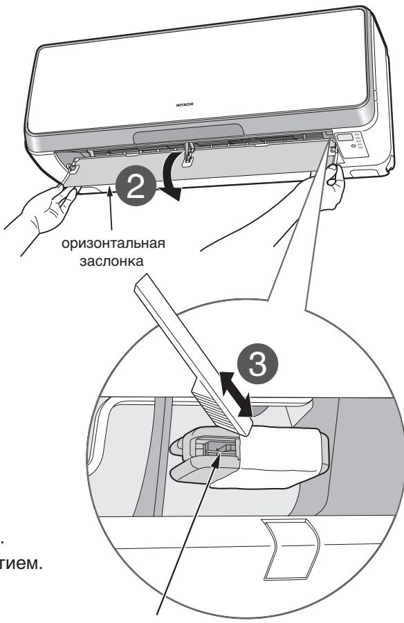
**3** Удалите грязь с электрического пылеулавливателя с помощью зубной щетки.
