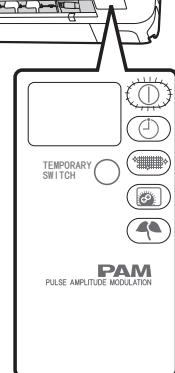
**3** После нажатия аварийного выключателя кондиционер начнет работу автоматически.
