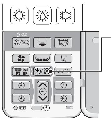
Нажмите кнопку (РУЧНАЯ ОЧИСТКА) при нажатой кнопке (ВКЛ/ОТКЛ.) (и не отпускайте их в течение 5 с).
