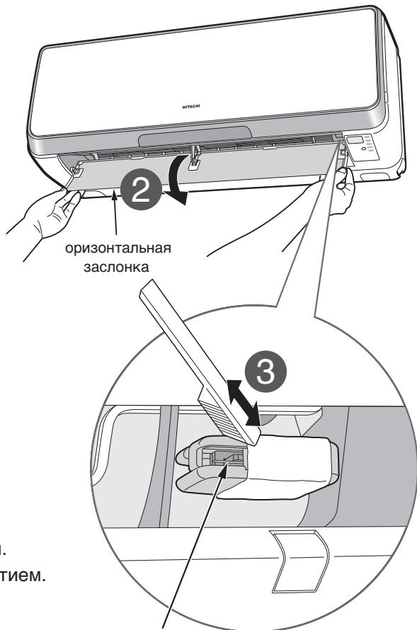
**3** Удалите грязь с электрического пылеулавливателя с помощью зубной щетки.
