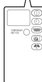
**3** После нажатия аварийного выключателя кондиционер начнет работу автоматически.
