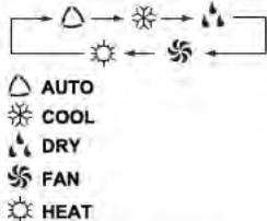
При включении прибор по умолчанию установлен на AUTO (АВТОМАТИЧЕСКИЙ РЕЖИМ РАБОТЫ). В режиме AUTO температура на дисплее не отобразится, в режиме HEAT (ОБОГРЕВ) первоначально установится температура 28°C, во всех остальных режимах первоначально установится 25°C.
