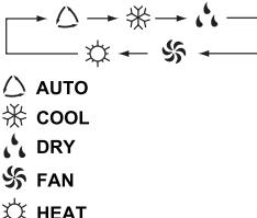
При включении прибор по умолчанию установлен на AUTO (АВТОМАТИЧЕСКИЙ)
