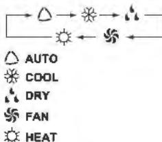
При включении прибор по умолчанию установлен на AUTO (АВТОМАТИЧЕСКИЙ РЕЖИМ РАБОТЫ). В режиме AUTO температура на дисплее не отобразится, в режиме HEAT (ОБОГРЕВ) первоначально устанавливается температура 28°C, во всех остальных режимах первоначально устанавливается 25°C.
