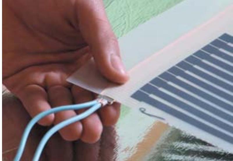
Рис. 14. Соединение монтажных проводов с контактным зажимом
