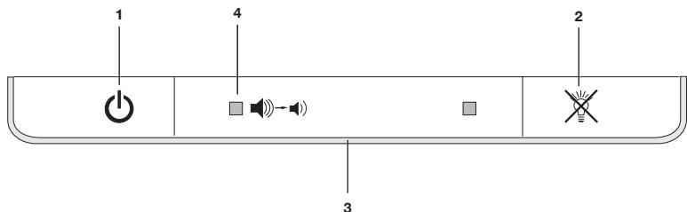
1 Включение/выключение кондиционера "⊕". Включение/выключение кондиционера. При нажатии кнопки включения кондиционер начнет работать, при этом режим работы и скорость вращения вентилятора будут установлены в автоматический режим. При повторном нажатии кондиционер будет выключен.
