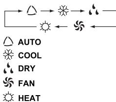
При включении прибор по умолчанию установлен на AUTO (АВТОМАТИЧЕСКИЙ РЕЖИМ РАБОТЫ). В режиме AUTO температура на дисплее не отобразится, в режиме HEAT (ОБОГРЕВ) первоначально установится температура 28°C, во всех остальных режимах первоначально установится 25°C.
