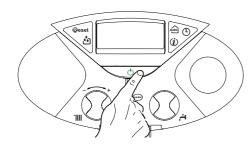
Полное выключение котла осуществляется переводом внешнего двухполюсного выключателя в положение ОFF (ВЫКЛ); дисплей при этом гаснет.
