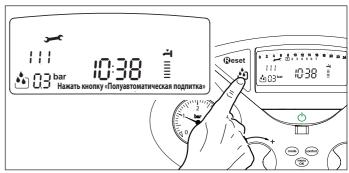
Котел следует перезапустить, а контур отопления подпитать, нажав кнопку "Полуавтоматическая подпитка".
