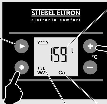
Стандартная индикация отображает объем воды, имеющейся в наличии. Например: 159 литров
