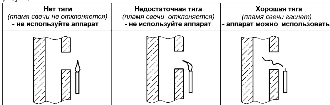
Рисунок 7. Способ проверки тяги в дымоходе
