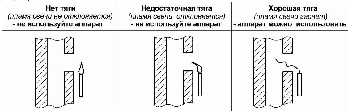
Рисунок 4. Способ проверки тяги в дымоходе
