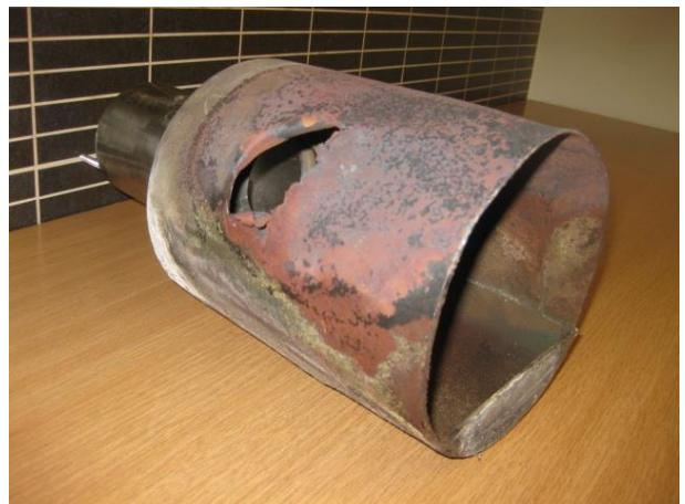
**Фото 1 Деформированная решетка и прогоревшая камера сгорания**
