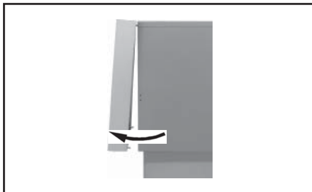
Рис.: Демонтаж лицевой части котла
