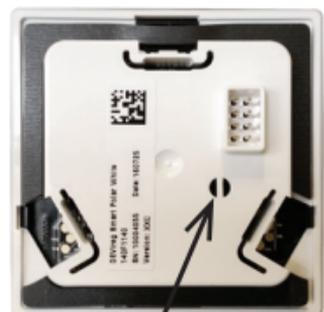
Можно также установить режим «только датчик температуры воздуха»; для этого необходимо сломать, например с помощью отвертки, маленькую пластмассовую перемычку на задней части модуля дисплея. После
