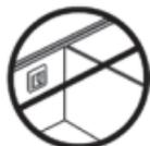
Не размещайте терморегулятор на внутренней стороне плохо изолированной наружной стены.
