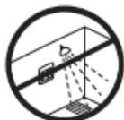
Не следует устанавливать терморегулятор в помещениях с повышенной влажностью. Термостат должен размещаться за пределами зоны 2. Разместите его в соседнем помещении и используйте режим «только датчик температуры пола». При установке терморегулятора соблюдайте местные нормы по IP-классам защиты.
