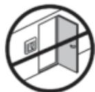
В режиме совместного использования датчика температуры пола и датчика температуры воздуха или в режиме использования только датчика температуры воздуха всегда размещайте терморегулятор на расстоянии не менее 50 см от окон и дверей во избежание влияния сквозняков.
