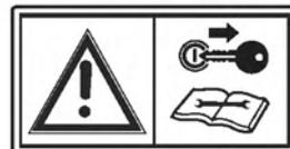
Перед проведением работ по техническому обслуживанию и ремонту извлеките ключ из замка зажигания!
