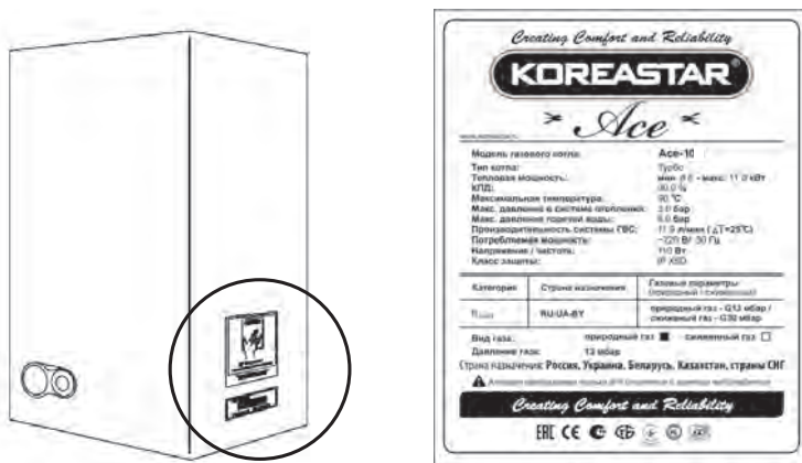
Рис. 15. Расположение технического шильда
