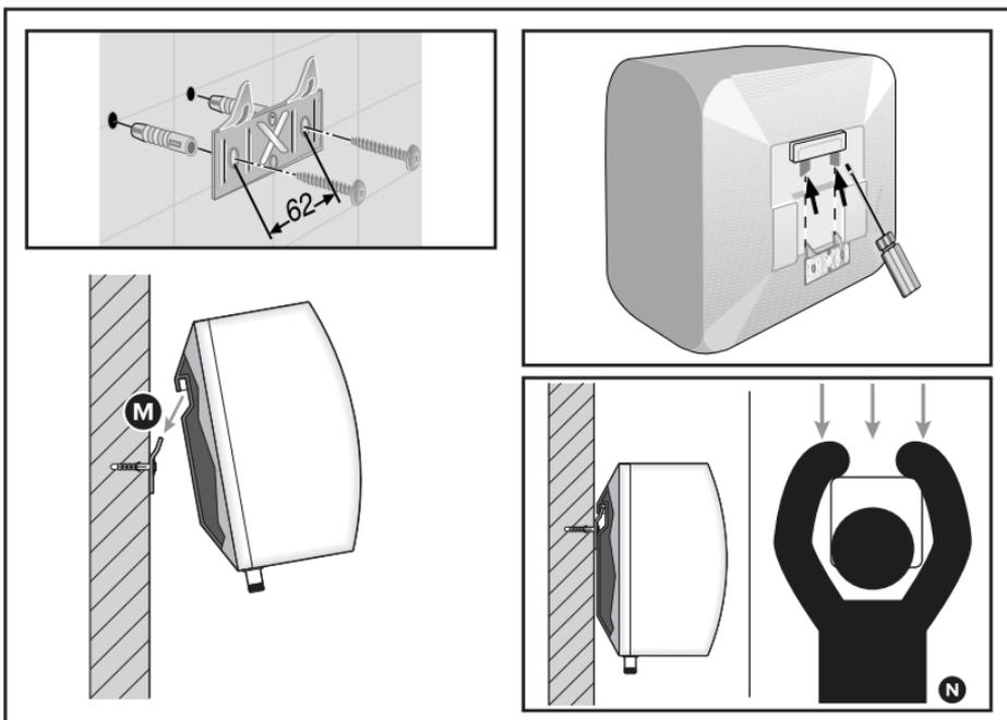
Installation scheme - Схема установки
