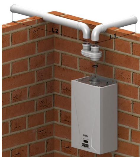
Рис. 6 Схемы присоединения отдельного дымохода Ø 80 мм к котлу и установка диафрагмы
