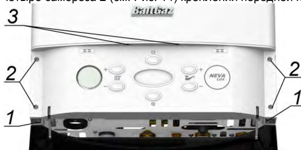
Рис. 14. Демонтаж облицовки и передней панели
