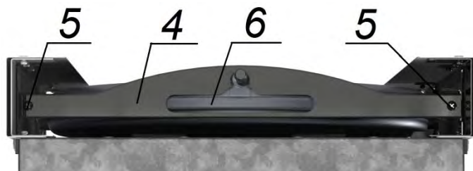
Рис. 21. Демонтаж расширительного бака
