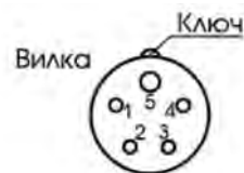
1, 2, 3 – фазы L1, L2, L3; 4 – N; 5 – заземление PE.
