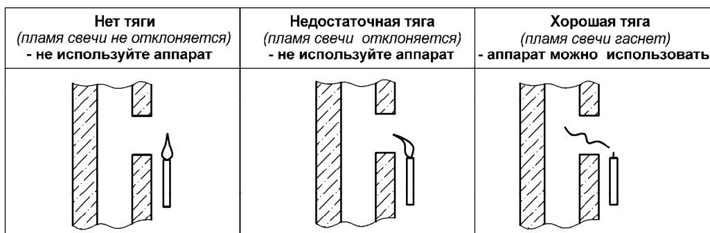
Рисунок 4. Способ проверки тяги в дымоходе
