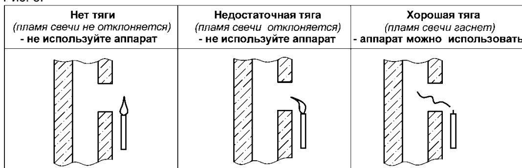
Рис. 6. Способ проверки тяги в дымоходе
