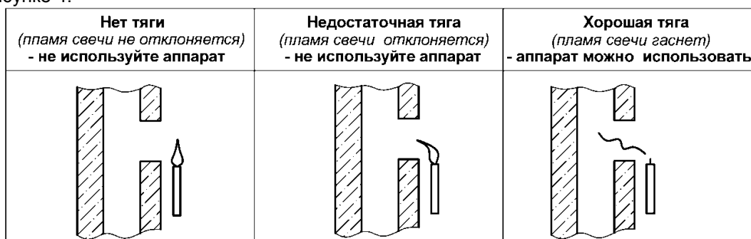
Рис. 4. Способ проверки тяги в дымоходе
