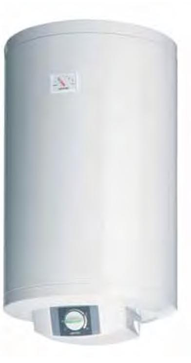
Водонагреватели GBFU E оснащены электронным управлением с терморегулятором, который позволяет точно устанавливать температуру в диапазоне от 10 до 75°C и контролировать расход магниевого анода. Водонагреватели предназначены для вертикального и горизонтального монтажа (присоединительные трубы располагаются слева) и благодаря уменьшенному внешнему диаметру (454 мм) подходят для установки в помещениях, где необходимо экономить пространство.
