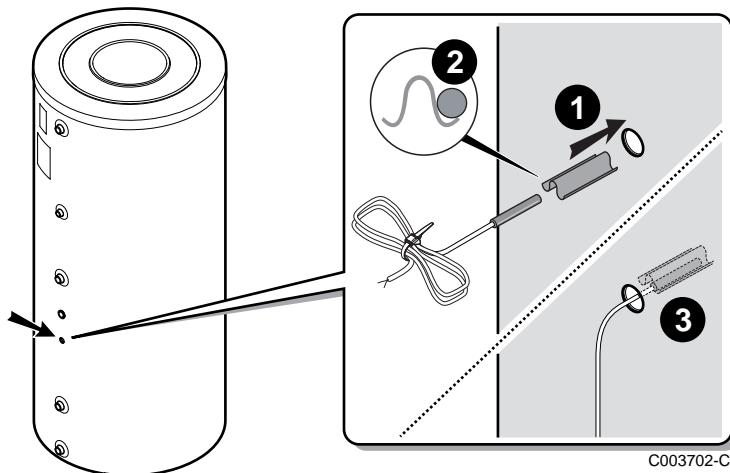
1. Установить датчик в приёмную гильзу при помощи разделителя приёмной гильзы.
