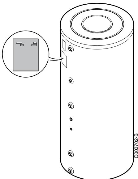
Наклеенная на водонагреватель идентификационная табличка содержит основную информацию об оборудовании : серийный номер, модель и т.д..
