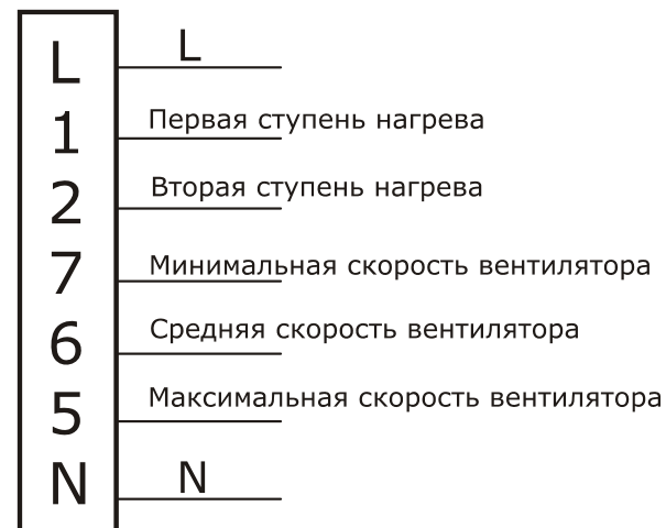
Рис. 4. Электрическая схема подключения пульта управления
