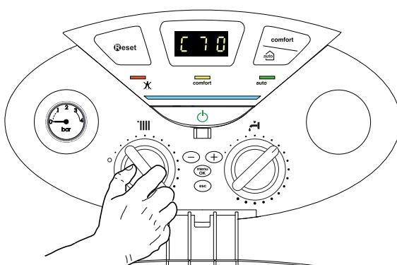
Значение регулировки отображается на дисплее и мигает.
