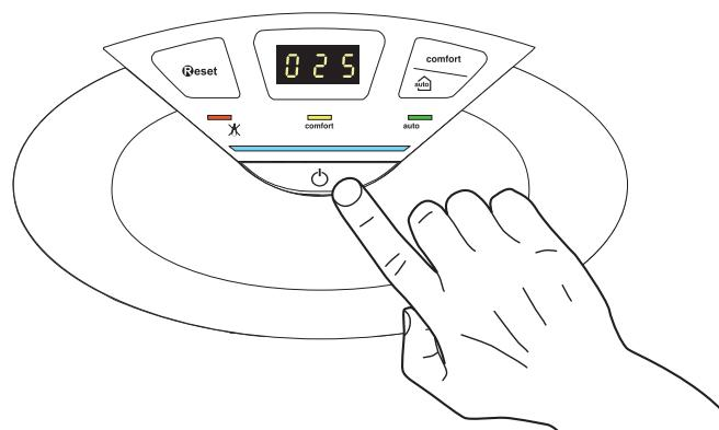
Pentru a opri definitiv cazanul, poziționați întrerupătorul electric extern pe OFF; displayul se va stinge.
