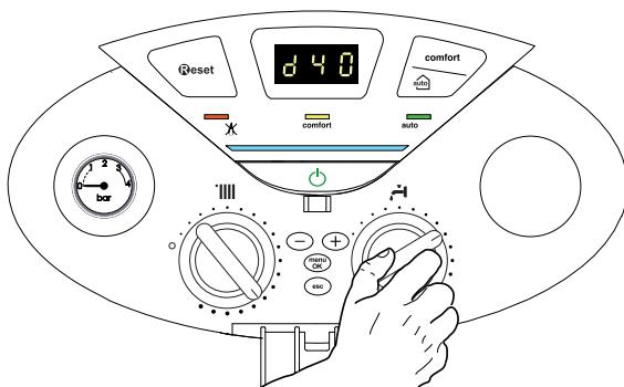
Temperatura poate fi verificată pe display-ul digital.
