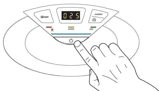
Для полной остановки котла отключите его электропитание внешним переключателем. Дисплей гаснет.
