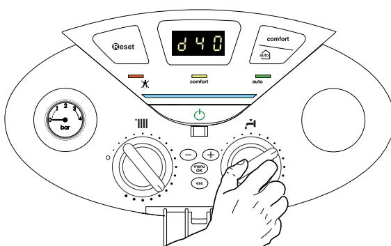
Значение регулировки отображается на дисплее и мигает.
