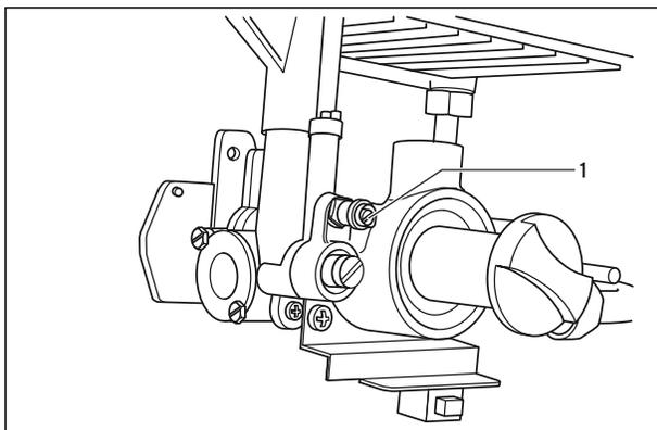
Рис. 6.4 Штуцер для измерения давления на соплах
