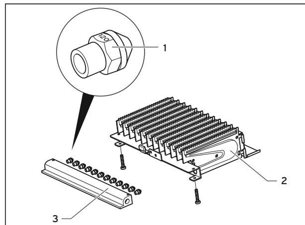
Рис. 6.6 Маркировка сопла
