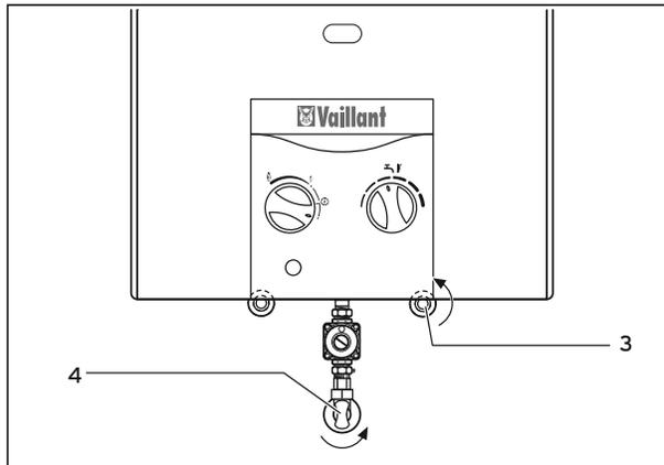
Рис. 4.2 Запорные устройства
