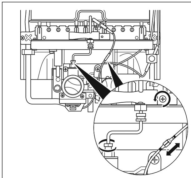
Рис. 7.1 Демонтаж фильтра запального газа и электрода розжига
