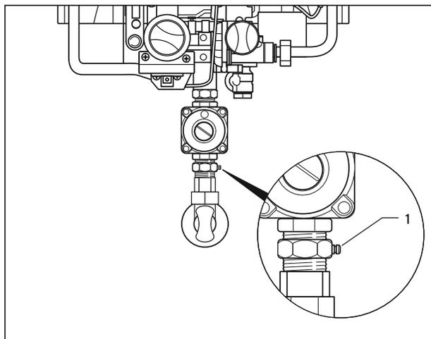
Рис. 6.1 Патрубок для измерения давления газа на входе
