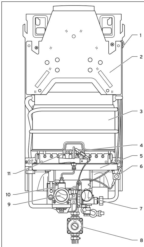
Рис. 2.1 Узлы водонагревателя atmoMAG 14 0/0 типа RXZ
