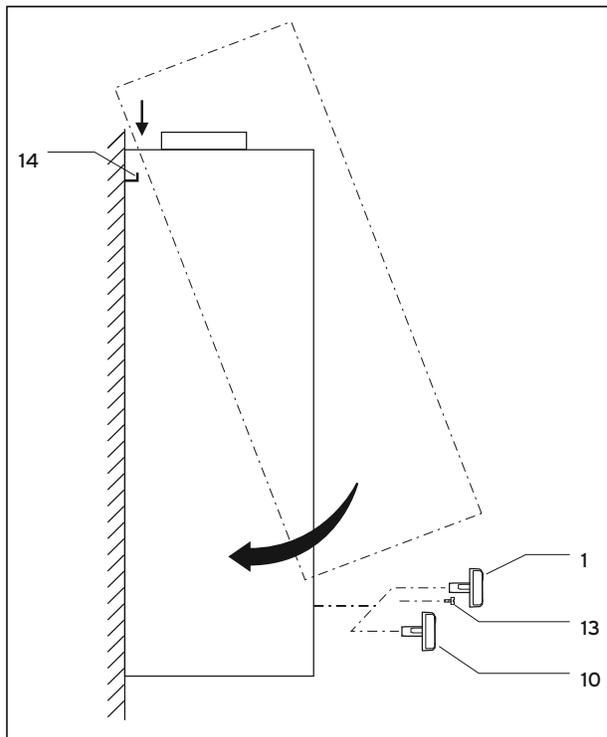
Рис. 4.5 Установка кожуха
