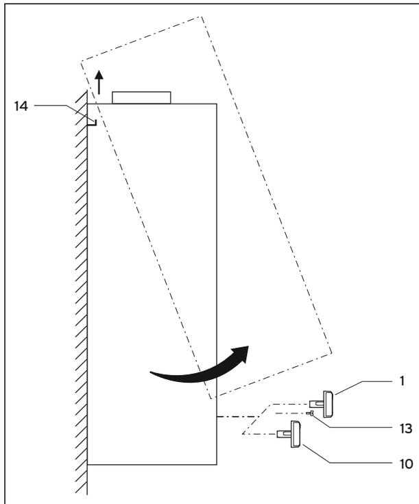
Рис. 4.4 Снятие кожуха
