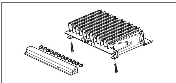
Рис. 7.3 Конструкция горелки
