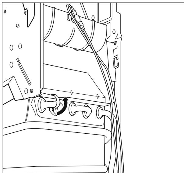
Рис. 7.5 Демонтаж теплообменника
