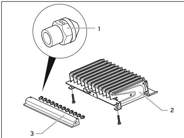
Рис. 6.3 Маркировка сопла
